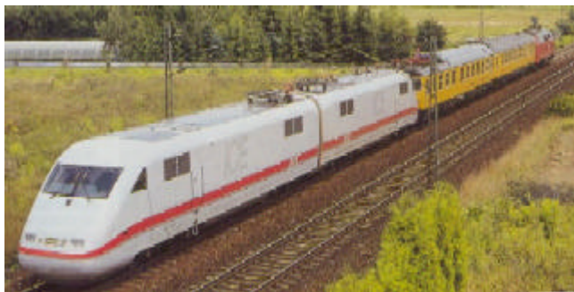
Una corsa prova delle motrici dell'ICE-H alimentate dalla carrozza misure
