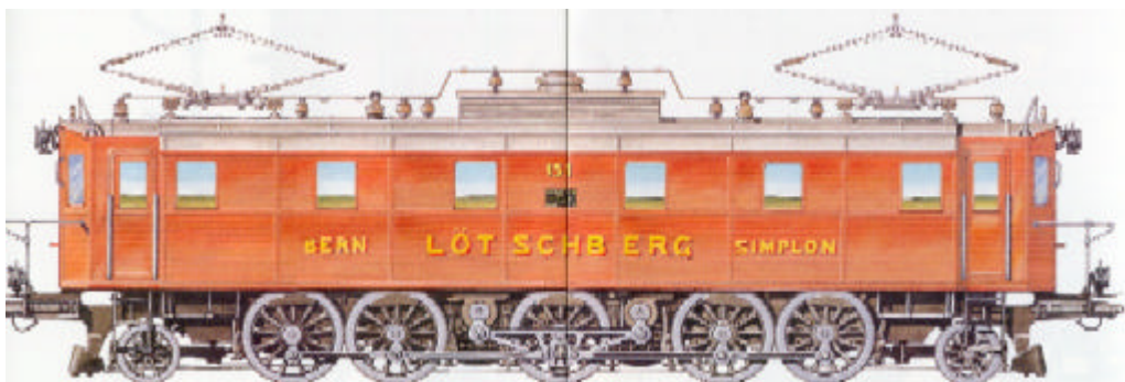
Locomotiva trifase delle compagnie del Löt Schberg, utilizzata per servizi tra Berna e Domodossola sulla linea del Sempione negli anni '30 - '40
